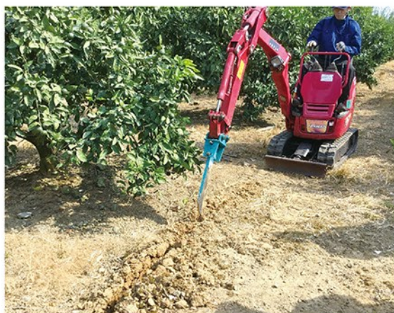
ナイフ状の断根刃をバックホウに装着して行う断根処理。
